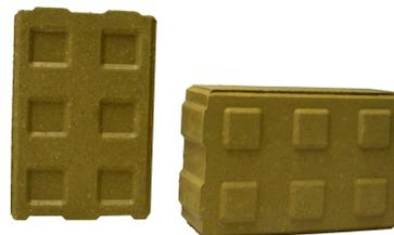
Marc ALGAYRES (malheureusement disparu en juillet 2007) et Thierry PERROCHEAU ont eu l'idée, en 2006, de moderniser et mécaniser la fabrication de la brique de terre crue compressée, ce matériau traditionnel de construction, naturel et économique. Un nouveau procédé ludique et pratique a vu le jour : il s'appuie sur la revalorisation de la terre extraite sur le chantier pour fabriquer les briques qui servent à la construction des murs du bâtiment.
